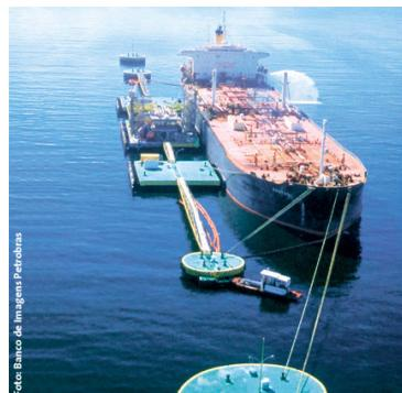
*Foto: Banco de Imagens Petrobras***EN:** Oil tanker *neutro***ES:** Petrolero *masculino***FR:** Navire citerne *masculino***def:** Um petroleiro é um tipo particular de graneleiro, utilizado para o transporte de hidrocarbonetos, nomeadamente petróleo bruto (petroleiros para pretos) e derivados (petroleiros para brancos).
