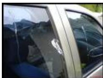
**def:** conjunto de vidro situado na parte lateral do carro com a forma aproximada da porta que abre e fecha com o objectivo de entrada de ar
