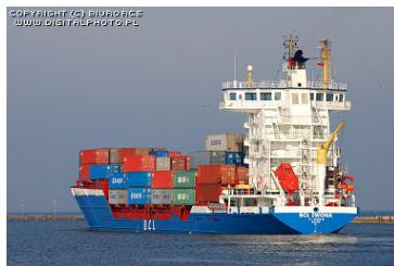
**def:** O navio porta-contentores é concebido especificamente para o transporte de contentores, os porões são equipados com guias ou celas, para receber e estivar os contentores "à medida", agilizando as operações de carga e descarga.
