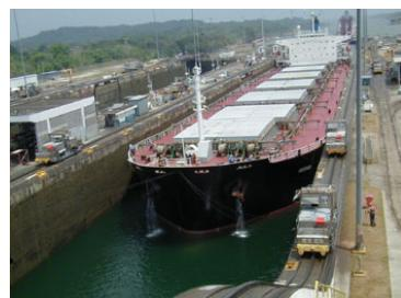
**def:** Panamax (a forma PanMax também é empregada) é um termo que designa os navios que, devido às suas dimensões, alcançaram o tamanho limite para passar nas eclusas do Canal do Panamá. Isso significa um comprimento de 1000 pés (305 m), uma largura de 110 pés (33,5 m) e uma profundidade de 85 pés (26 m).
