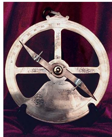
**def:** O astrolábio é um instrumento naval antigo, usado para medir a altura dos astros acima do horizonte.
