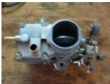
**def:** aparelho onde se efectua a mistura do ar atmosférico com o líquido combustível que se incendeia para fazer explosão
