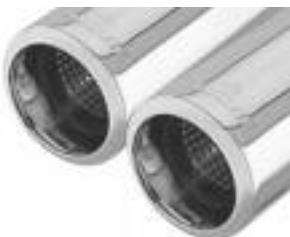
**def:** tubo por onde esses gases são expelidos do motor do veículo para o exterior
