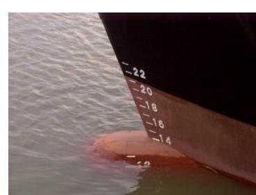
**def:** Calado é a designação dada à profundidade a que se encontra o ponto mais baixo da quilha de uma embarcação. O calado mede-se verticalmente a partir de um ponto na superfície externa da quilha.
