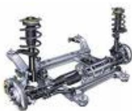
**def:** conjunto de molas, parafusos, articulações metálicas que servem como suporte da carroçaria e que se movem mediante o piso
