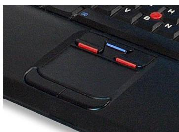
**def:** O Touchpad é um dispositivo sensível ao toque utilizado em portáteis (para substituir o rato) e é também encontrado em modelos recentes do iPod.
