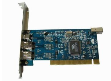
**def:** Uma placa controladora é uma parte do hardware de computadores que comanda outras partes da máquina.
