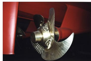
**def:** designa um conjunto de pás com um mesmo centro, que ao ser girado segundo o seu eixo causa propulsão e cada pás descreve no espaço uma trajectória que é, de facto, uma hélice geométrica.
