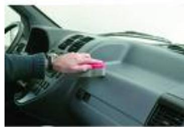
**def:** painel de fibra ou plástico que contém toda a parte frontal interior do veículo**FR:** tablier *masc.***EN:** front panel/ tablier
