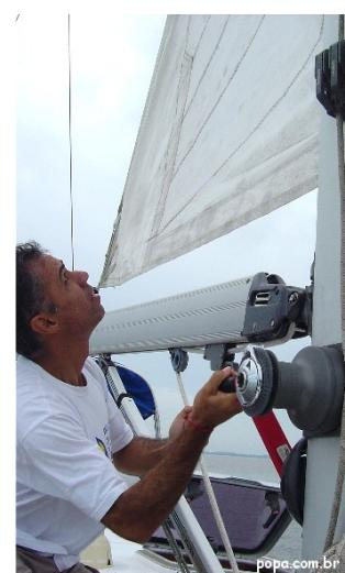
**def:** cabo atado à retranca do mastro da embarcação através da qual se controla a abertura da vela em relação ao vento.
