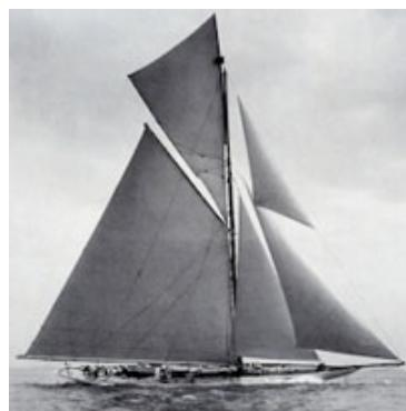
**def:** Um veleiro é uma embarcação propulsada por um velame, conjunto de velas de tecido de corte e formato apropriado, apoiado em um ou mais mastros e controlada por um conjunto de cabos chamado cordoalha. Possui também uma quilha e um leme que impedem a deriva e forçam o conjunto avante.
